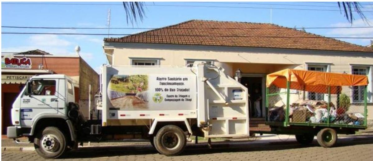
**Figura 90– Carroceria adaptada para coleta seletiva**
