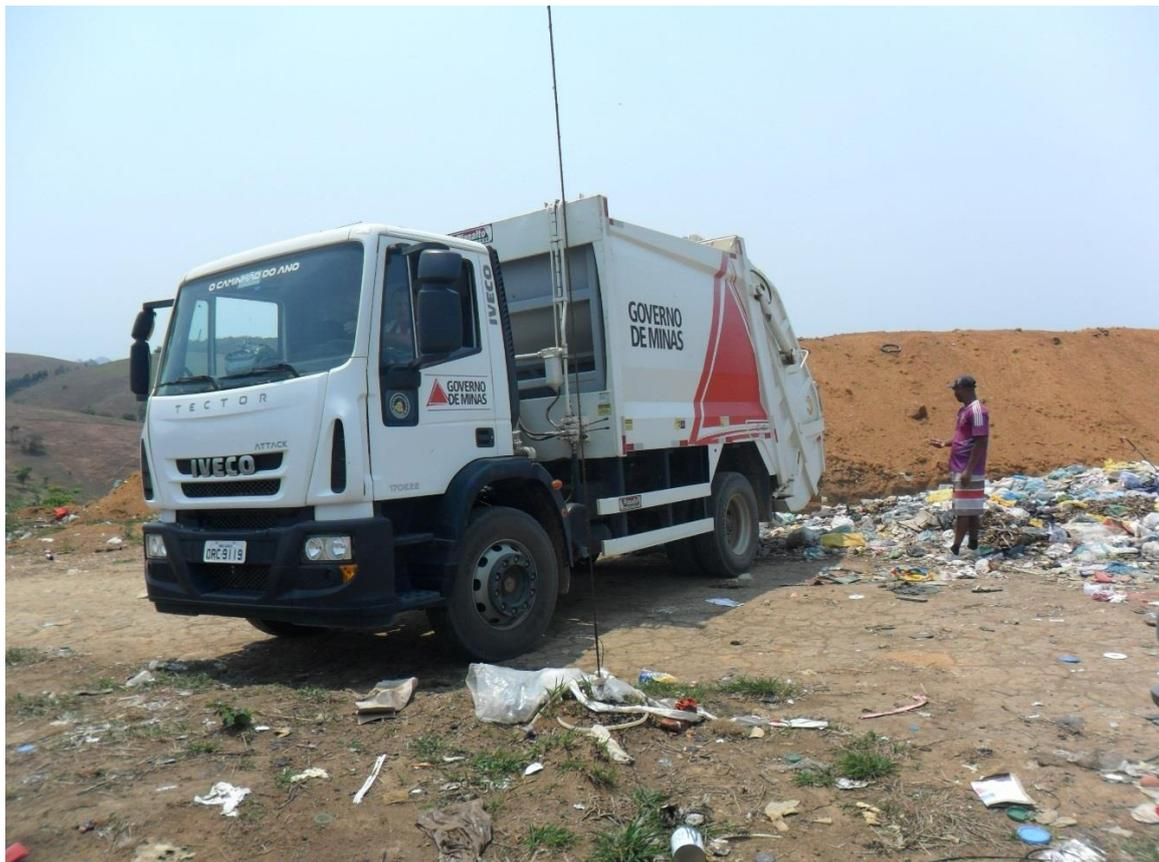
**Figura 38 - Caminhão compactador utilizado na coleta domiciliar**
