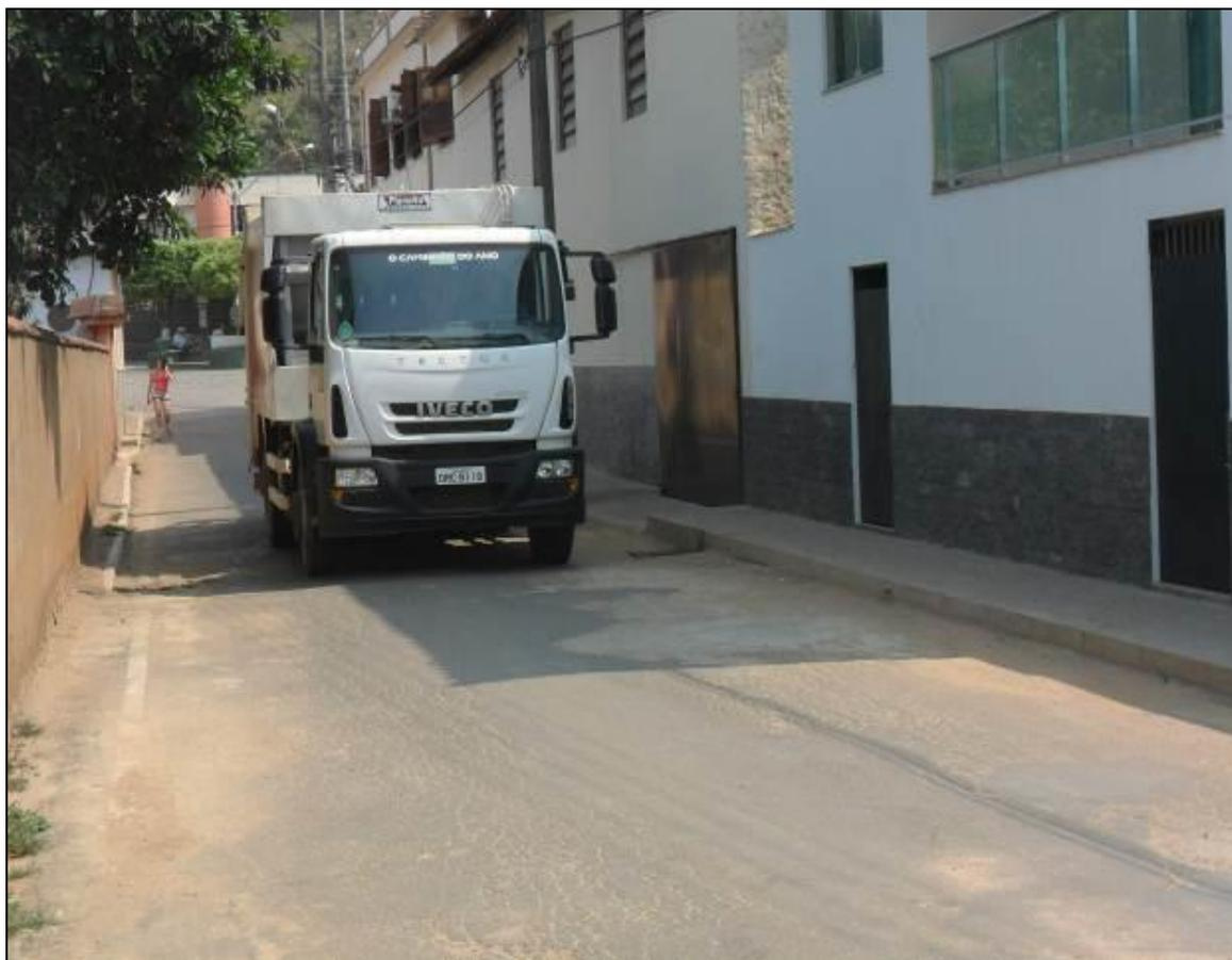
**Figura 79 - Caminhão compactador utilizado na coleta domiciliar no Distrito Sede**
