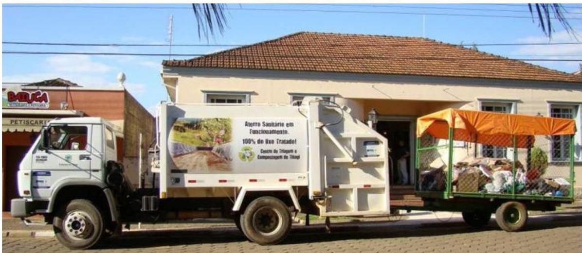
Figura 101 - Carroceria adaptada para coleta seletiva
