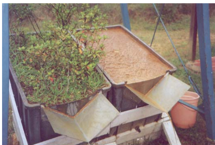
Demonstração com simulador de chuva do efeito da vegetação nas taxas de infiltração e de escoamento superficial e sub-superficial (Instituto Florestal - Cunha, SP).
