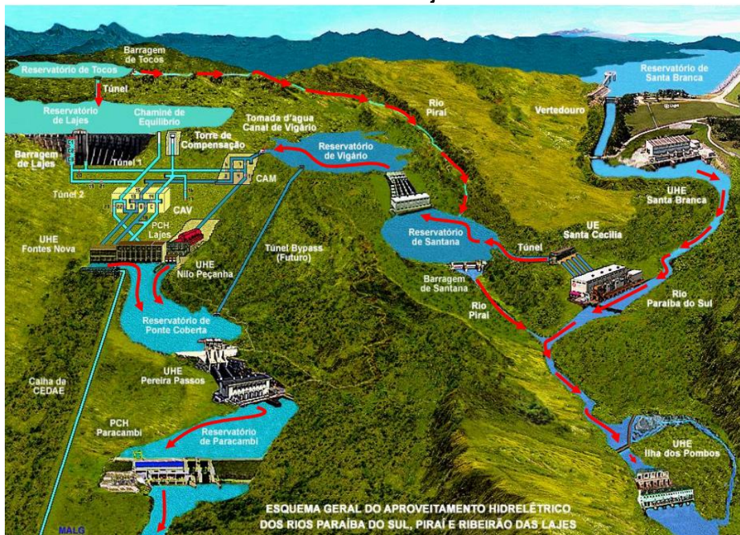
Figura 4-5 – Esquema Geral dos Aproveitamentos Hidrelétricos dos rios Paraíba do Sul, Pirai e Ribeirão das Lajes
