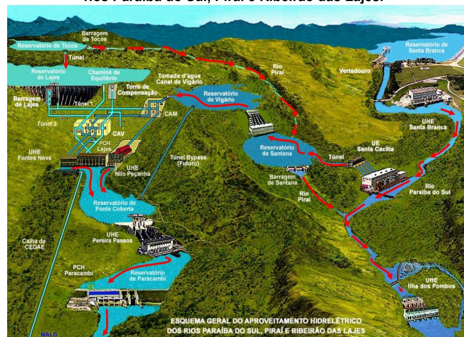
Figura 6-16 – Esquema Geral dos Aproveitamentos Hidrelétricos dos rios Paraíba do Sul, Piraí e Ribeirão das Lajes.
