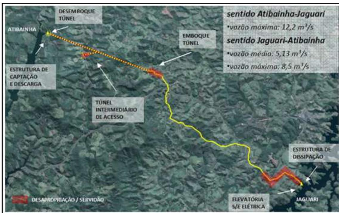
**Figura A1-** Arranjo Esquemático da Solução Jaguari – Atibainha (SABESP/PDAA)
