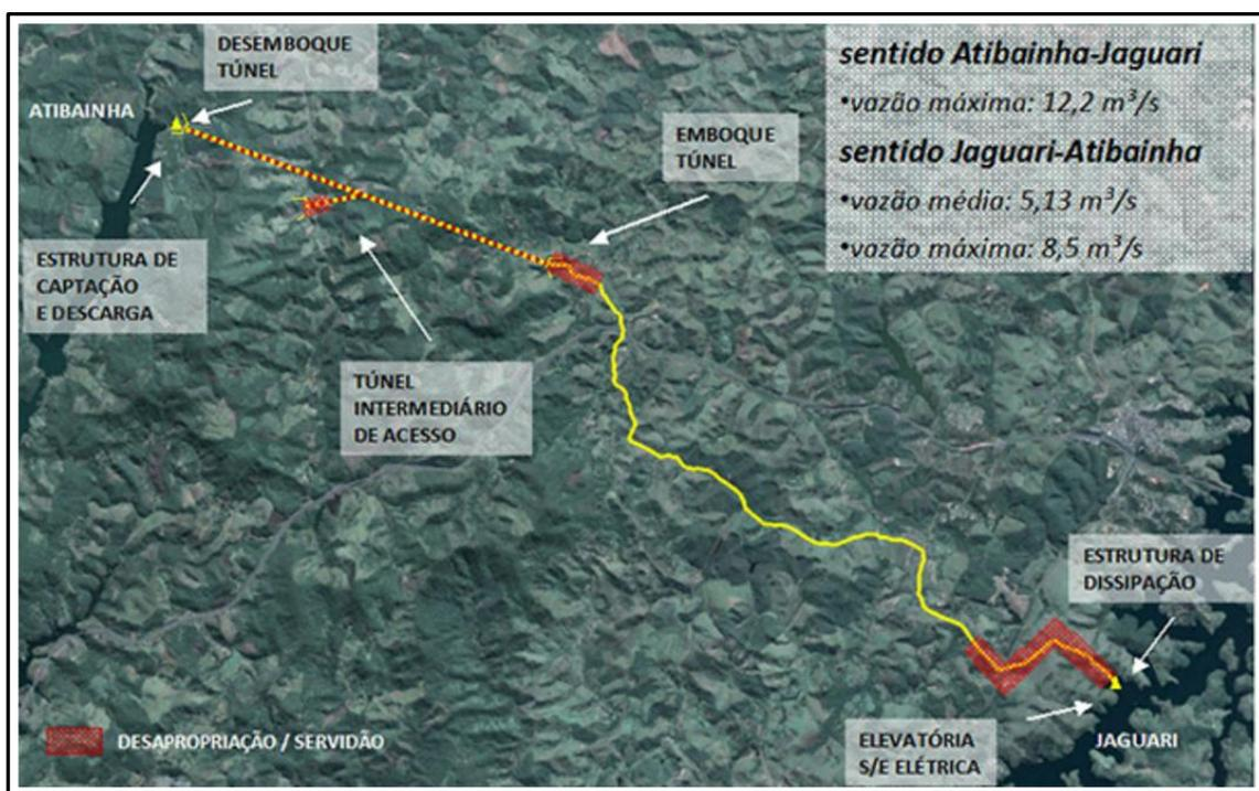
**Figura 10.1** – Arranjo Esquemático da Solução Jaguari – Atibainha (SABESP/PDAA)
