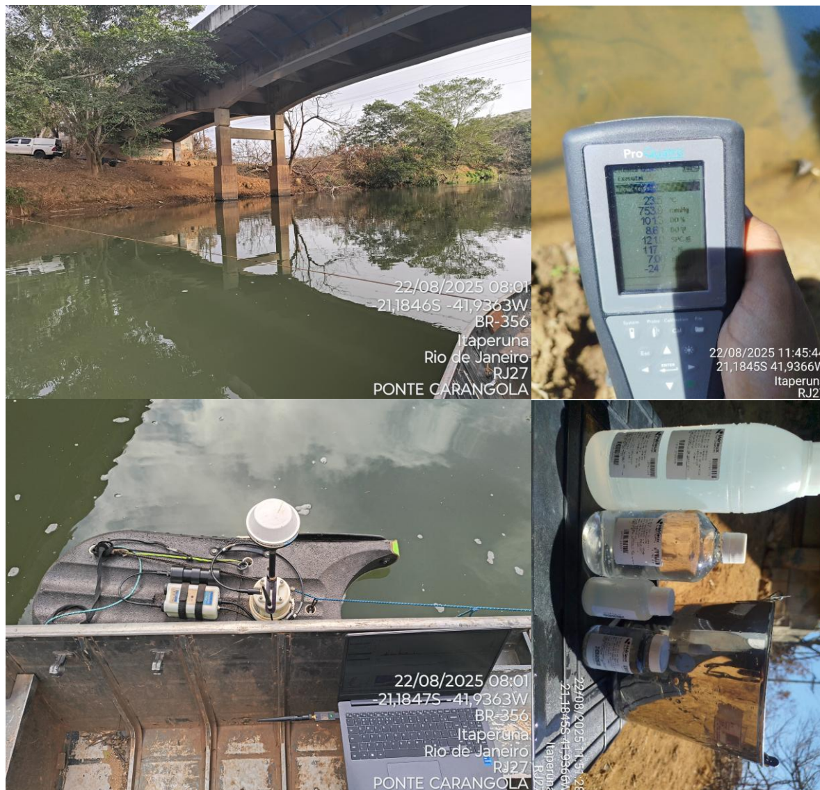
Figura 4.54. Registros fotográficos do ponto RJ27 - Ponte Carangola, destacando a seção de medição, a medição de vazão e de parâmetros de qualidade da água, e a coleta de amostras de água.
