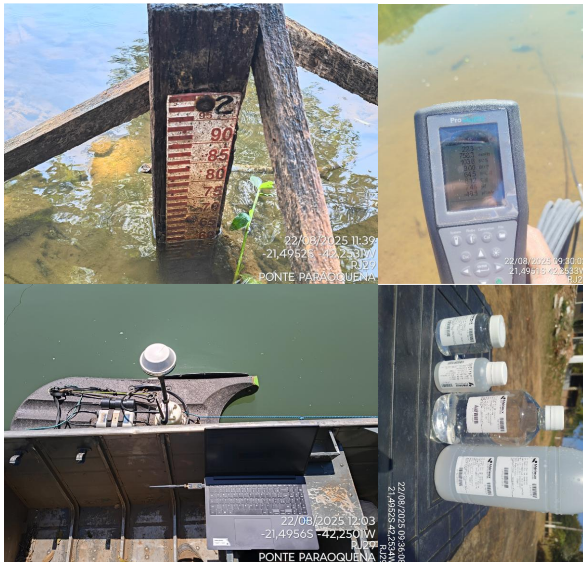
Figura 4.58. Registros fotográficos do ponto RJ29 - Ponte Paraquena, destacando a seção de medição, a medição de vazão e de parâmetros de qualidade da água, e a coleta de amostras de água.
