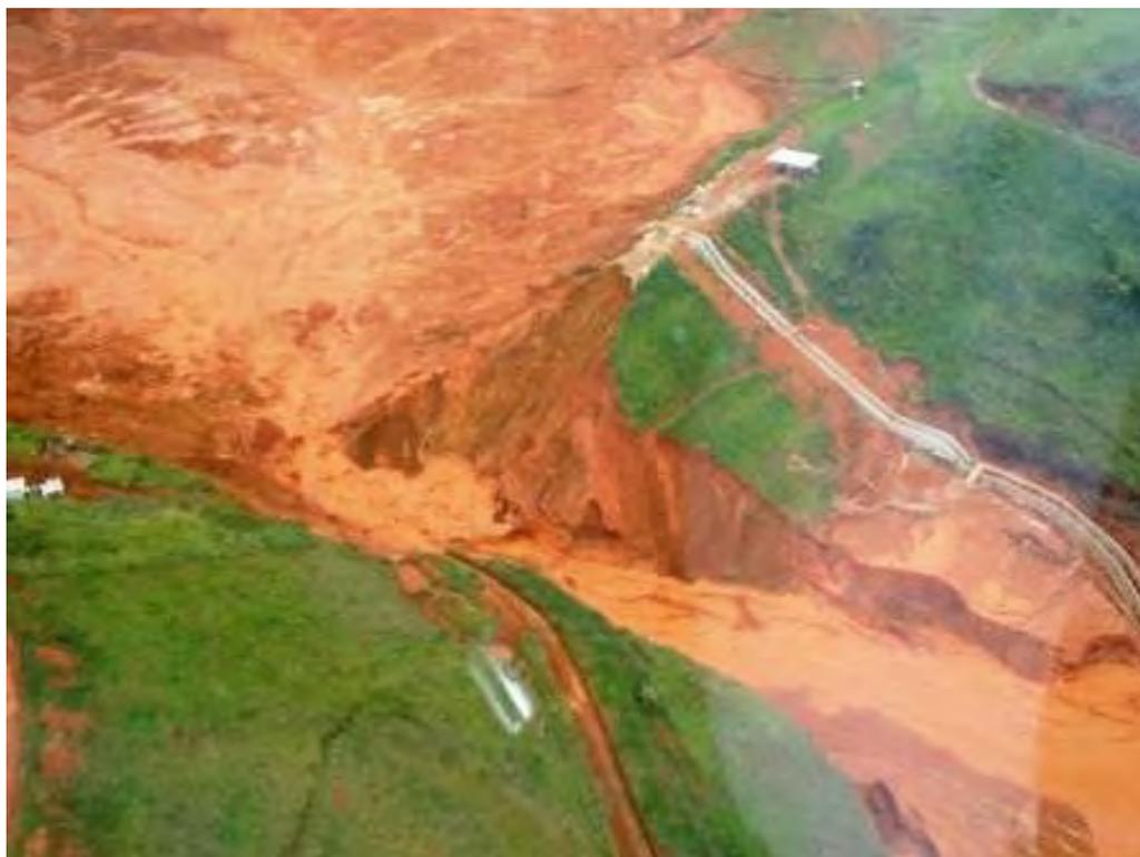
**Figura 9.4** Local da Ruptura da Barragem de Rejeitos
