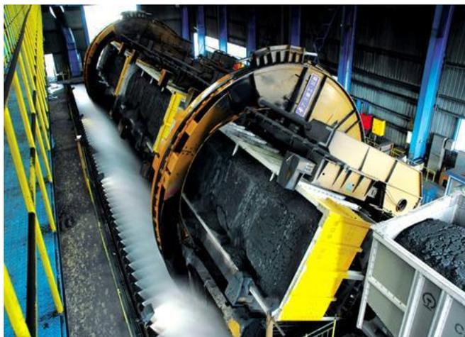
**Figura 7:** Virador Triplo de Vagões
