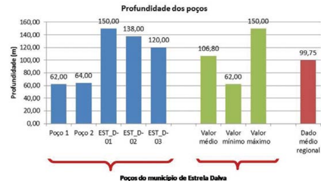
Figura 8 – Profundidade individual, mínima, máxima e média dos poços do município de Estrela Dalva, em comparação com o valor médio regional.
