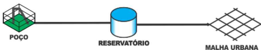
Figura 14: Diagrama do sistema de abastecimento de água potável de Divino – Bom Jesus e Córrego dos Viletes Fonte: Conen
