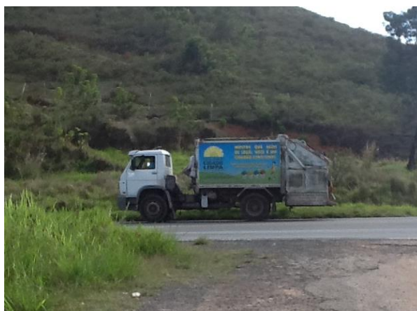
Figura 67: Veículo de coleta de resíduos sólidos do município - caminhão compactador Fonte: Conen
