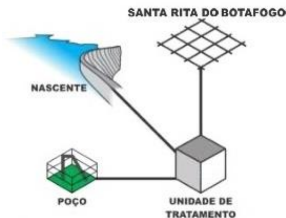
Figura 14: Diagrama do sistema de abastecimento de água potável do Distrito de Santa Rita do Botafogo Fonte: Conen
