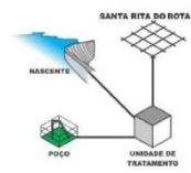
Figura 1: Diagrama do sistema de abastecimento de água potável do Distrito de Santa Rita do Botafogo Fonte: Conen
