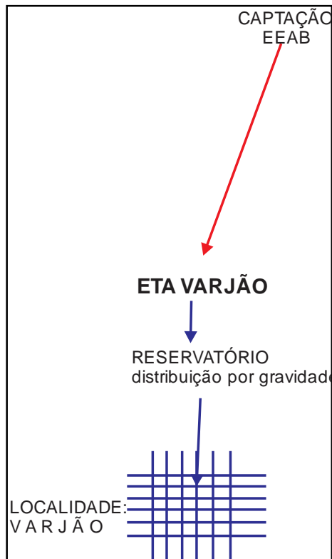
Figura 42 – Sistema de abastecimento no bairro Varjão no distrito Arrozal
